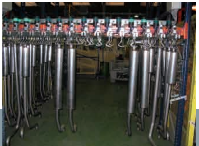
Rampa de almacenamiento intermedio inteligente para la fabricación de referencias muy variadas
