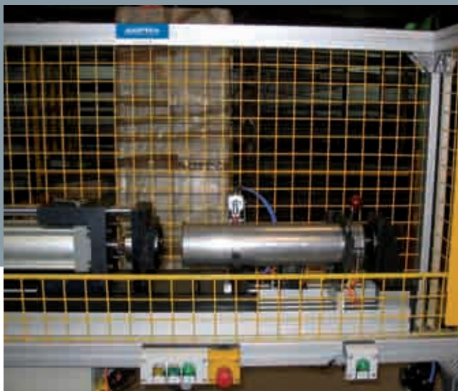
Máquina y útil de clavado de tapas exteriores, con barrera de seguridad y detección de posición correcta (pokayoke)
